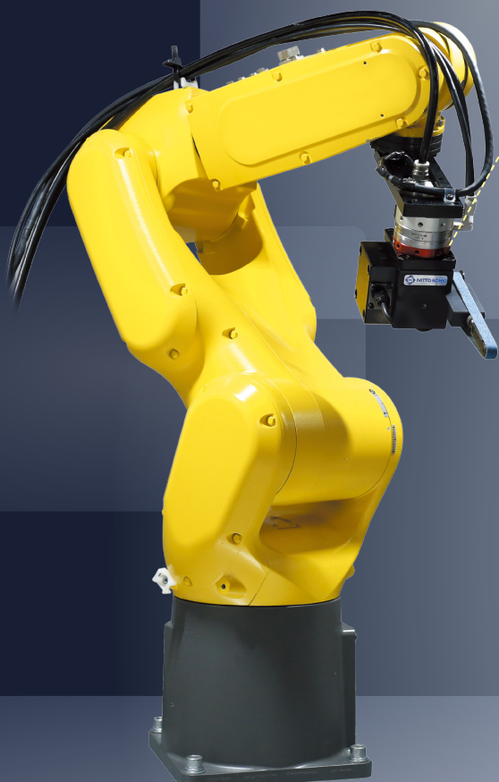
6軸ロボットへの取付例
