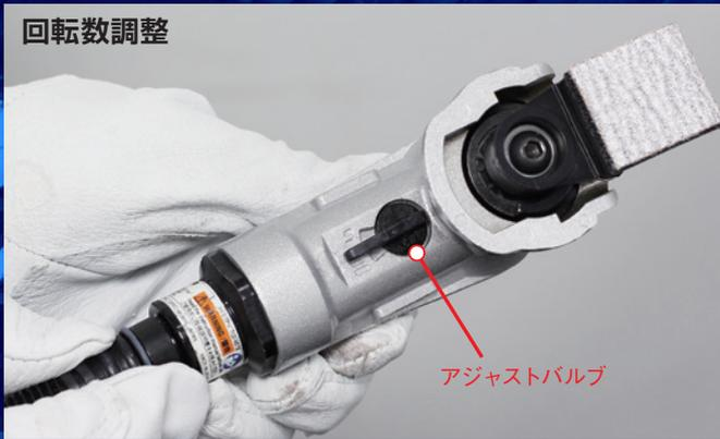
アジャストバルブを回すと空気流量が変わり、回転数を調整することができます。ワークの材質やペーパー粒度等、仕上げ面を見ながら調整してください。
