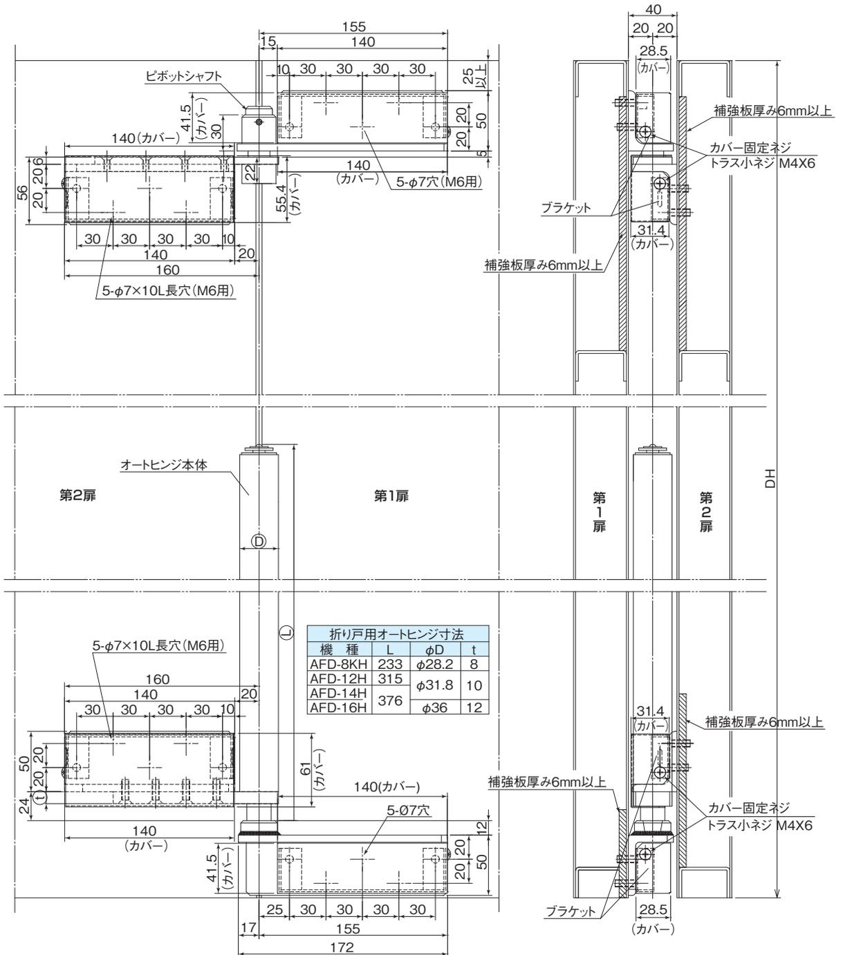
記事 ① 本図は、2枚折戸セカンドヒンジ(カバー付セット)左開き勝手 外形寸法納まり図を示します。右開き勝手は本図と対象になります。
