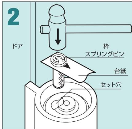
●ドアを10°くらい開きセット穴を合わせ、スプリングピンを確実に打ち込んでください。打ち込み方向は、スプリングピンの台紙の説明に従ってください。
