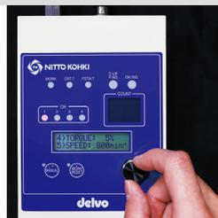
外部コントローラで回転数を設定。100~1,000min<sup>-1</sup>の範囲で調整が可能。
