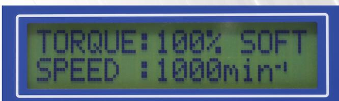
表示例: ねじ締めモード (SOFT 設定時)
