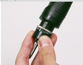
ドライバ先端のトルク調整リングを回してトルクを調整。
