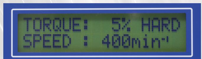
表示例: ねじ締めモード (HARD 設定時)
